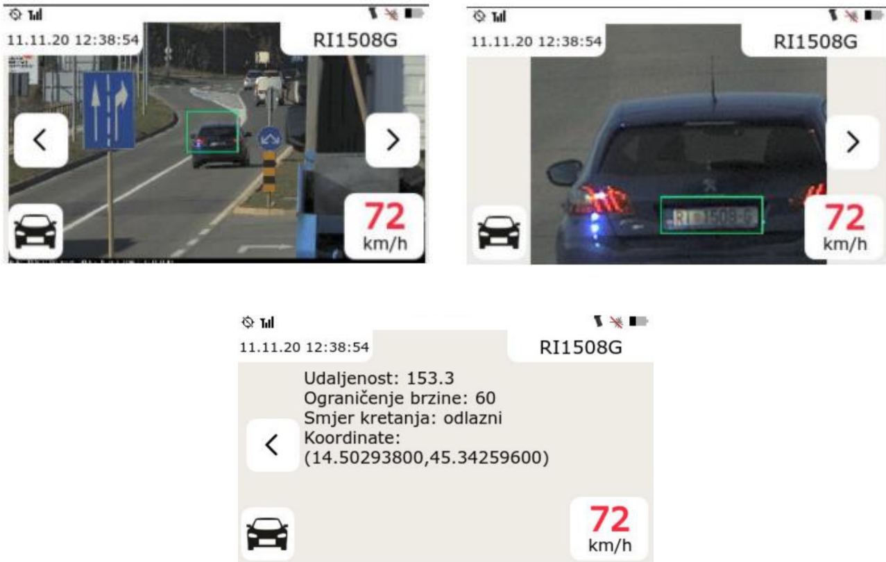
Slika 4. Prikaz pohranjenih podataka o registriranim slučajevima prekošenja podešenog ograničenja brzine na LCD zaslonu mjerila (vrijeme fotografiranja vozila, automatski očitana registarska oznaka, izmjerena brzina kretanja vozila, uvećana fotografija snimljenog vozila sa čitljivom registarskom tablicom, te tekstualni podaci)
